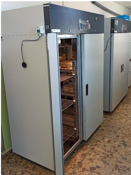
Obrázek S4. Klimaboxy s nerezovým vnitřkem, nucenou cirkulací, monitoringem teploty a vlhkosti.
