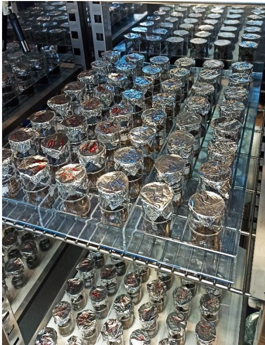
Obrázek S4. Klimaboxy s nerezovým vnitřkem, nucenou cirkulací, monitoringem teploty a vlhkosti.
